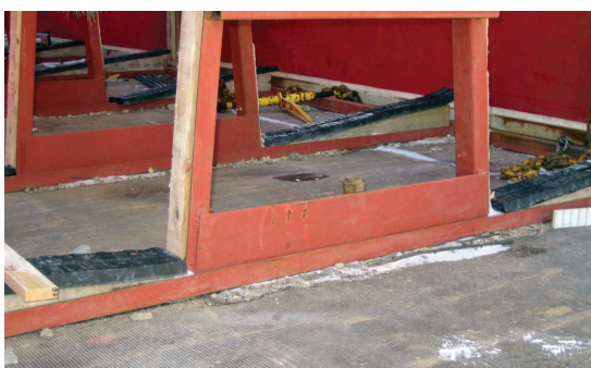
Siirrettävät pukit kiinnitetään lavaan toispuoleisen kuormituksen aiheuttaman kaatumisen estämiseksi.
