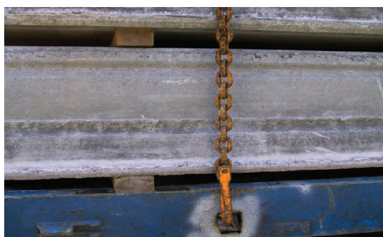
Ketjun sidontapisteet lavaan tulee varmistaa riittävälle voimalle.
