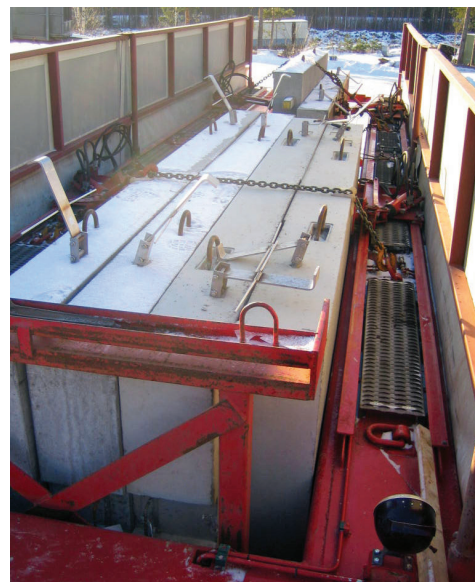
Seinäelementtien kuljetukseen on kehitetty myös erikoiskalustoa. Huomaa allasauton korkeat sivulaidat.
